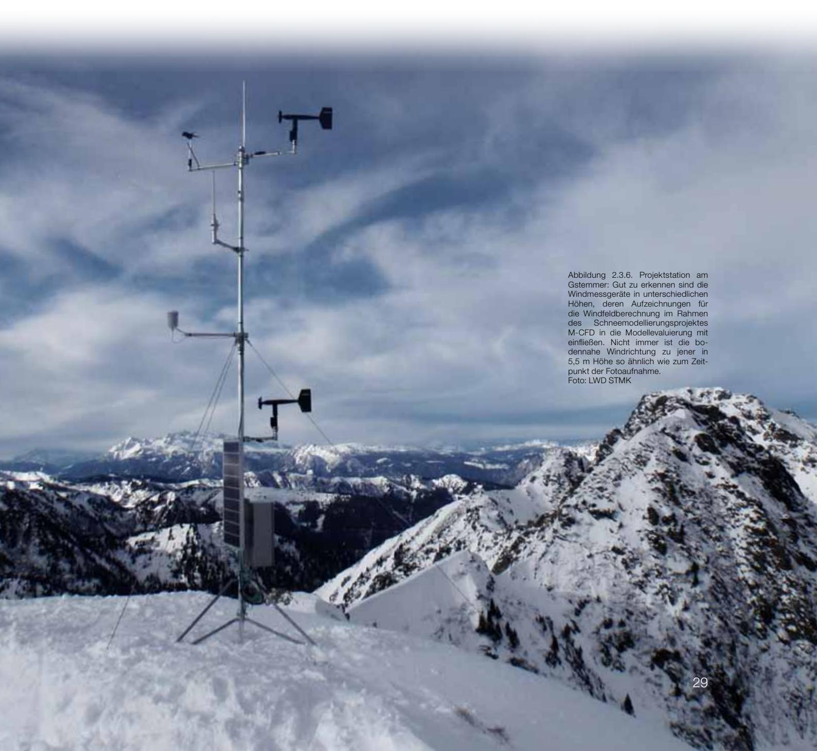
Abbildung 2.3.6. Projektstation am Gstemmer: Gut zu erkennen sind die Windmessgeräte in unterschiedlichen Höhen, deren Aufzeichnungen für die Windfeldberechnung im Rahmen des Schneemodellierungsprojektes M-CFD in die Modellevaluierung mit einfließen. Nicht immer ist die bodennahen Windrichtung zu jener in 5,5 m Höhe so ähnlich wie zum Zeitpunkt der Fotoaufnahme.
