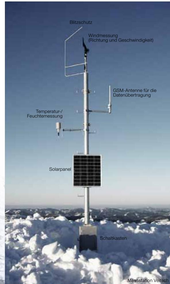
Abbildung 1.6.1. Typisches Stationspaar: Während der Wind meist an exponierten Gipfelbereichen gemessen wird, um eine möglichst freie Anströmung gewährleisten zu können, sind die Standorte der jeweiligen Schneepiegel an windgeschützten Stellen optimal, um eine vom Wind möglichst unbeeinflusste Messung zu erhalten. Vor allem die exponierten Gipfelstationen sind ganz besonders dem Problem der Vereisung und den damit verbundenen Beschädigungen oder Datenverlusten unterworfen.
